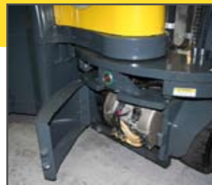
Moteur à courant alternatif 19.5kW (sans charbons)
